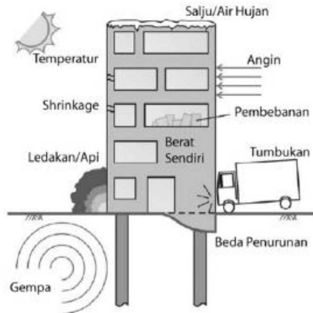
Gambar 2.3. Pembebanan pada Bangunan Gedung
