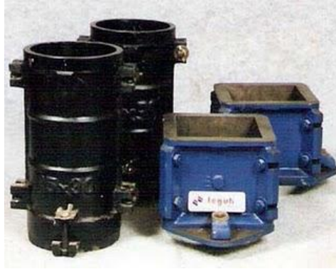
Gambar 2.1. Alat cetak beton Silinder dan Kubus
