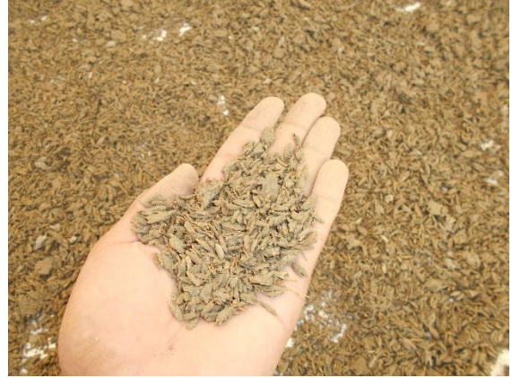
Gambar Hasil Sekam Padi campuran air semen
